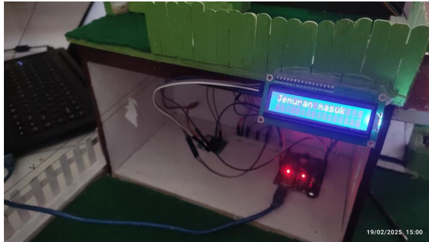
Gambar 4. 8 Pengujian sensor hujan saat kondisi hujan
