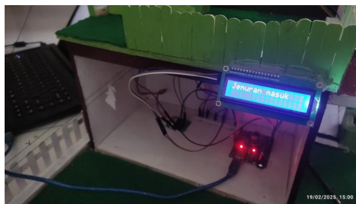
Gambar 4. 9 Pengujian sensor hujan saat kondisi hujan
