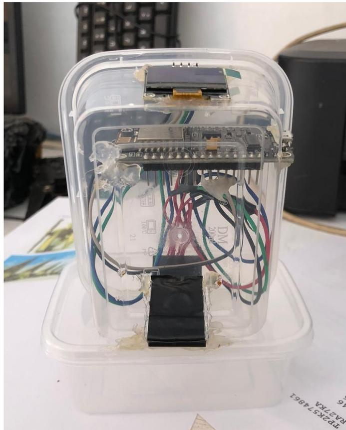
Gambar 4. 1 Rangkaian alat sistem absensi guru dengan NodeMCU ESP8266
