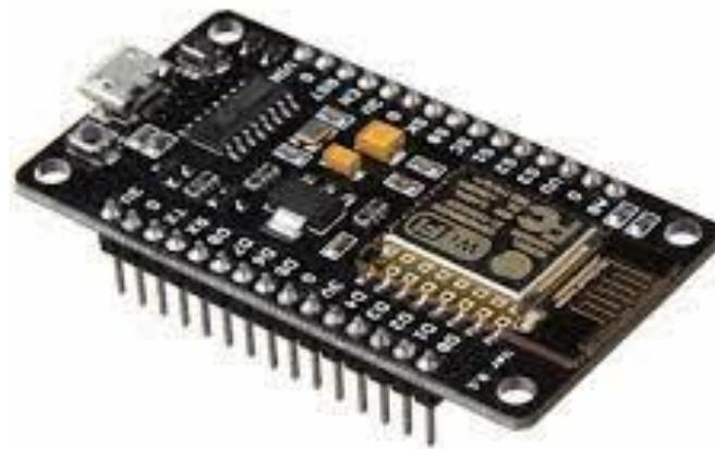
Gambar 3. 4 Mikrokontroler ESP8266
