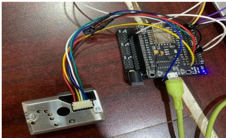
**Gambar 4. 4** Pengujian Sensor Debu Sharp GP2Y1010AU0F
