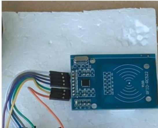
Gambar 4. 1 Rangkaian RFID
