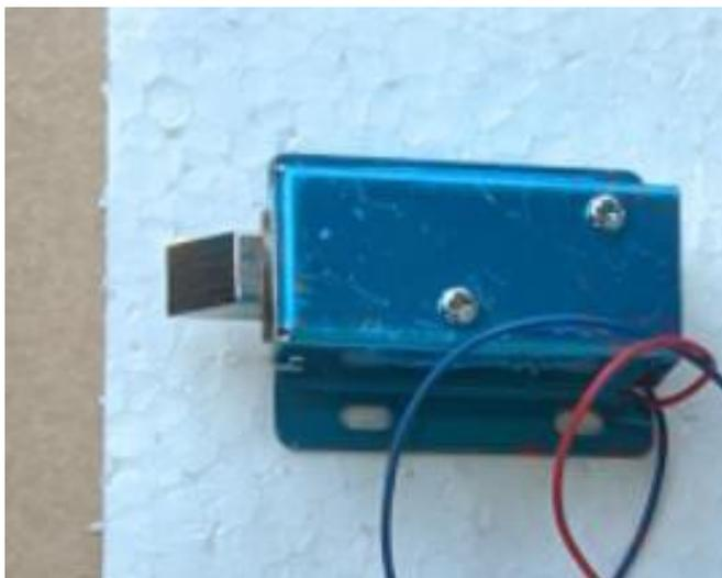
Gambar 4. 6 Rangkaian Solenoid
