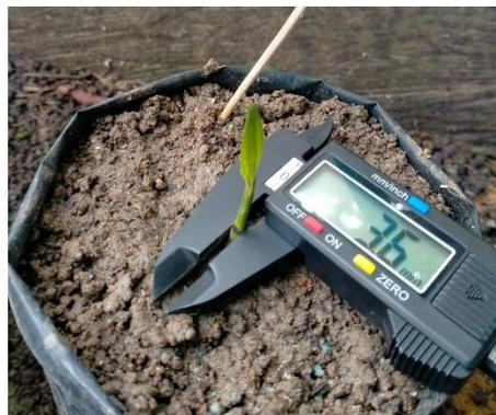
**Gambar 4.3 Pengukuran Diameter Batang Bibit Kelapa Sawit**
