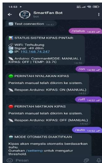
**Gambar 4.9 Pengujian Ke Telegram**
