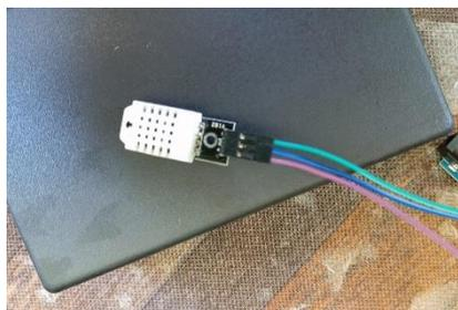
**Gambar 4.4 Rangkaian Sensor DHT22**
