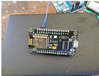
**Gambar 4.3 Rangkaian NodeMCU ESP8266**
