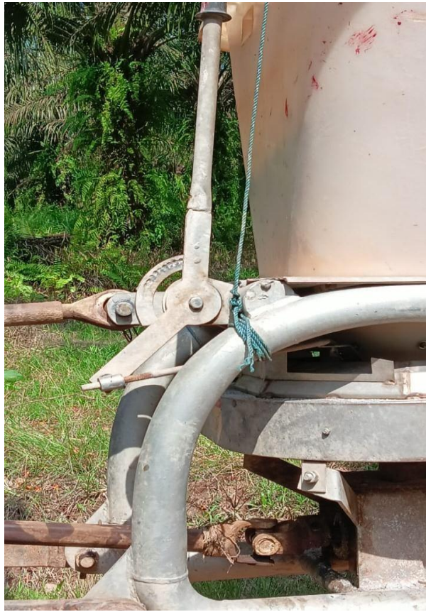
Gambar 1.7. Tuas dosis untuk Alat EMDEK
