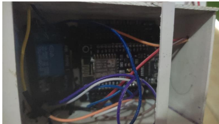
Gambar 4. 1 ESP8266 NodeMCU sebagai pusat kendali sistem.
