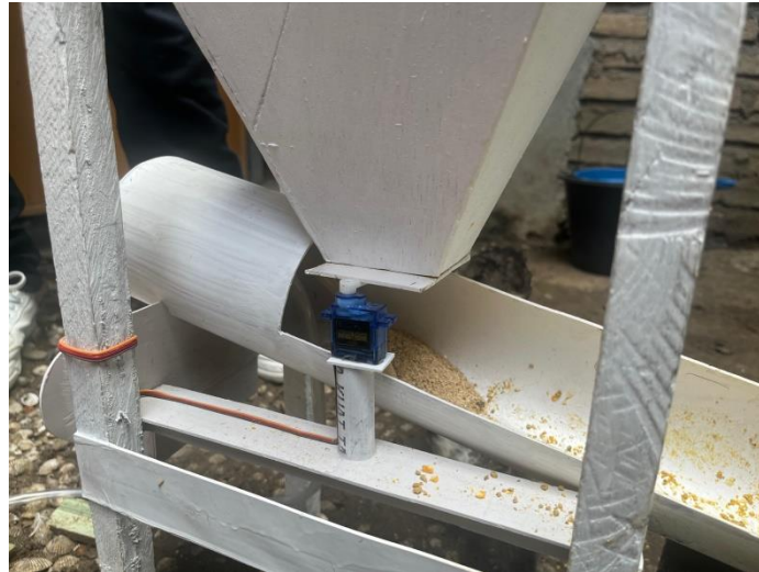
Gambar 4. 11 Servo Bergerak Membuka Tandon Pakan.
