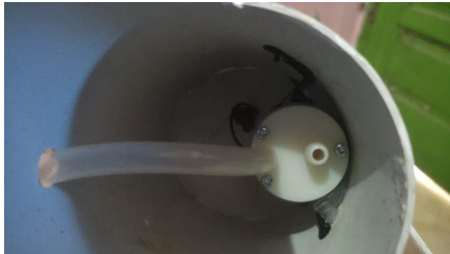
Gambar 4. 4 Pompa Air DC 12V untuk membasahi pakan dedak
