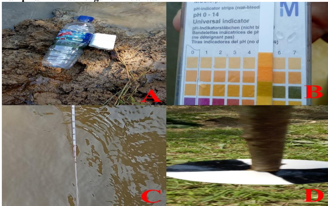
Gambar A. Alat Pengukur kecepatan Arus; B. pH Indikator; C. Termometer; D. Sechi Disk.
