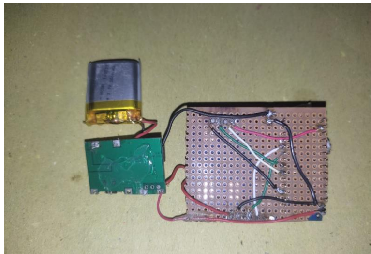
Gambar 4. 3 Wiring Perangkat GPS pada PCB
