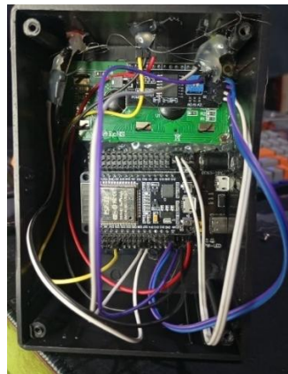
Gambar 4. 2 Rangkaian Sistem Pemantauan Indeks UV
