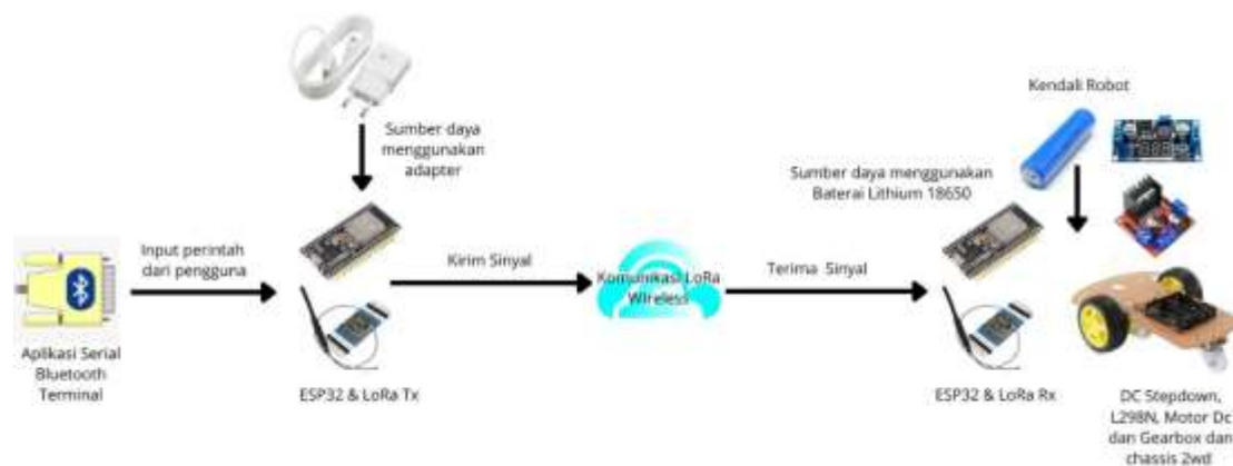
Gambar 3.3 Sistem Robot IoT dengan Kendali Suara
