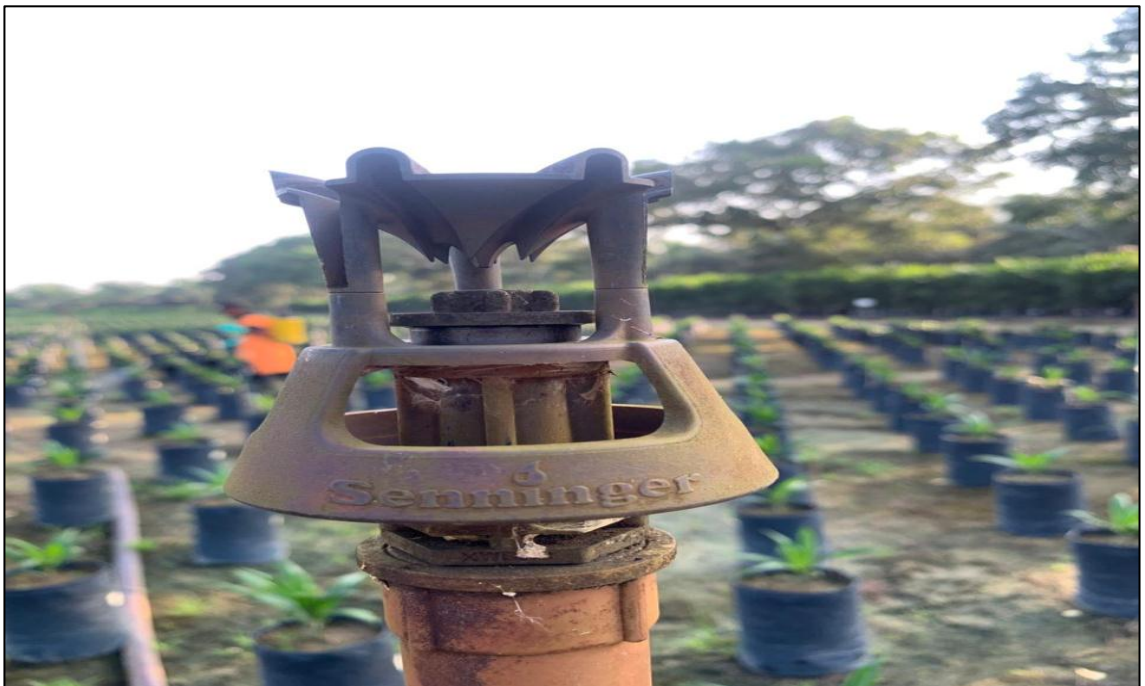
Lampiran 2. gambar alat penyiraman dengan sprinkler
