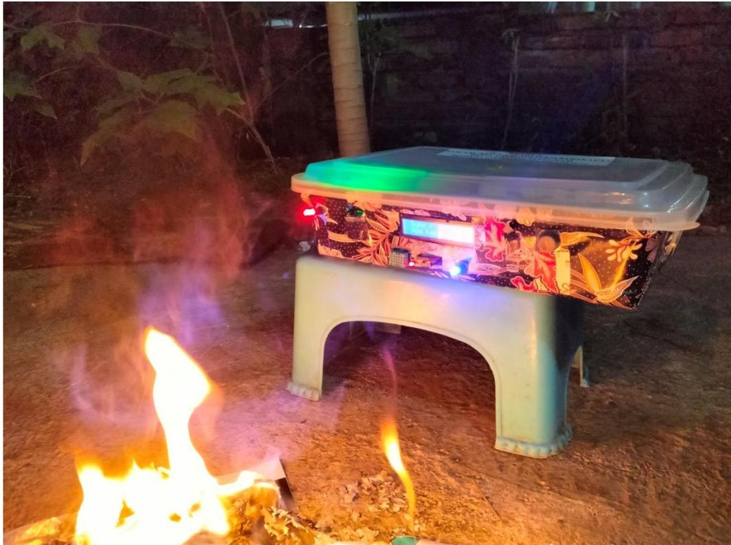
Gambar 4.9 Pengujian Sensor Suhu DHT11
