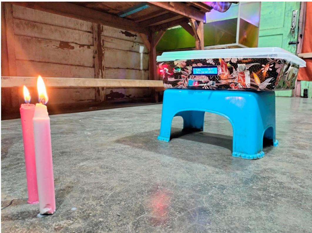
Gambar 4.7 Pengujian Sensor Api (*Flame Detector*)
