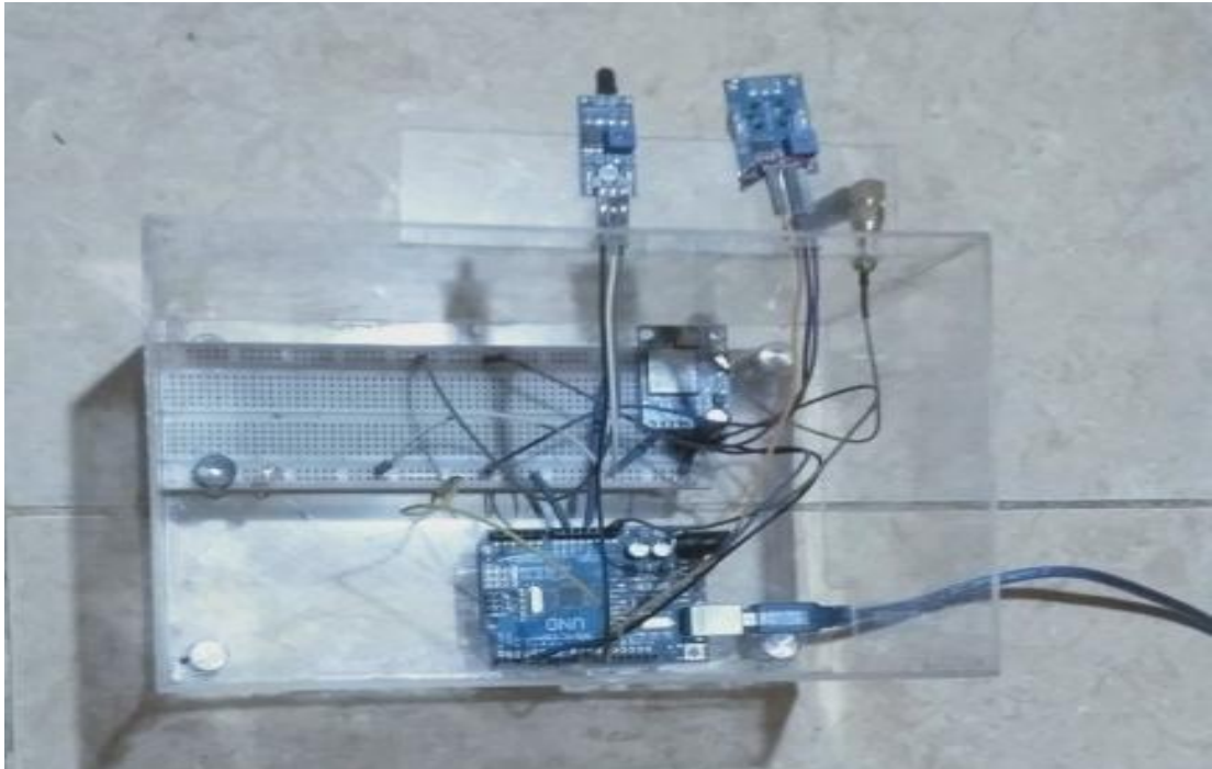
Gambar 4. 1 Hardware sistem deteksi kebakaran
