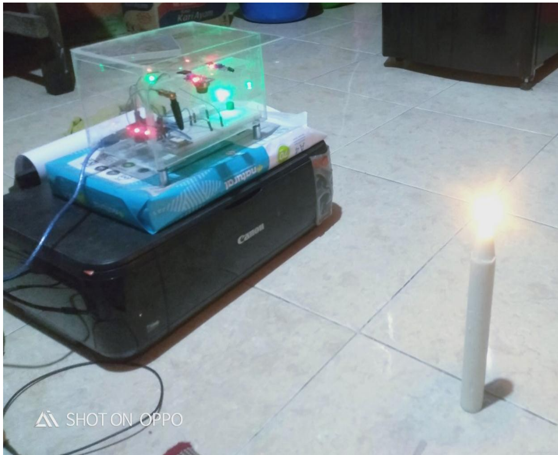
Gambar 4.8 Pengujian Sensor Api
