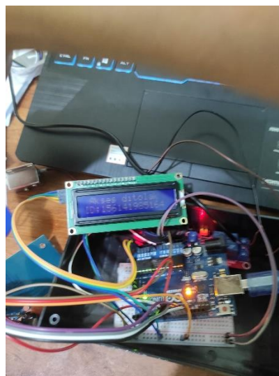
Gambar 8. Pengujian Penolakan Akses Dan Alarm
