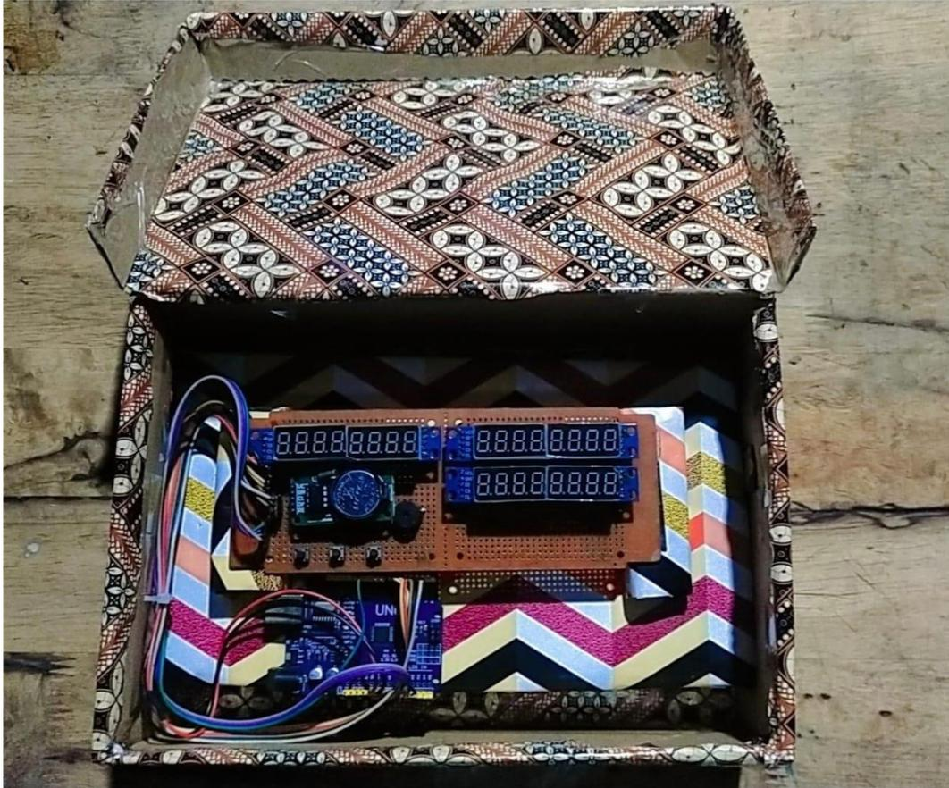
Gambar 4.3 Proses penghubungan arduino ke PCB Bolong
