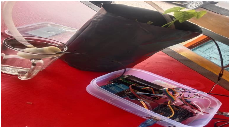
Gambar 4.4 sistem penyiraman otomatis pada tanaman
