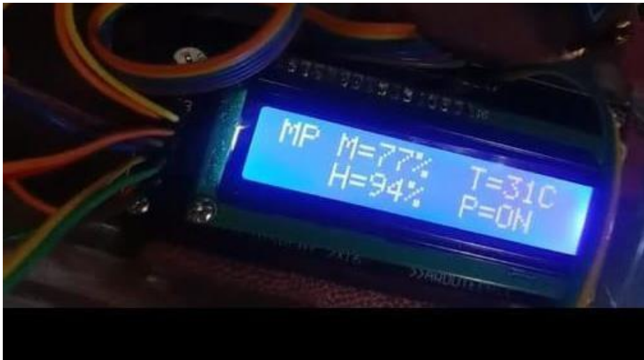
Gambar 4.10 hasil pengujian sensor dht11
