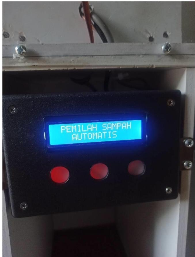
**Gambar 4.2** Tampilan LCD pada posisi stand by
