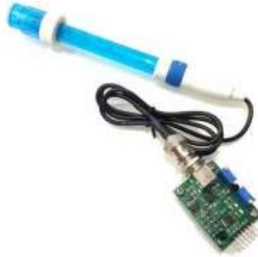
**Gambar 2.2** Tampilan sensor pH 4502C
