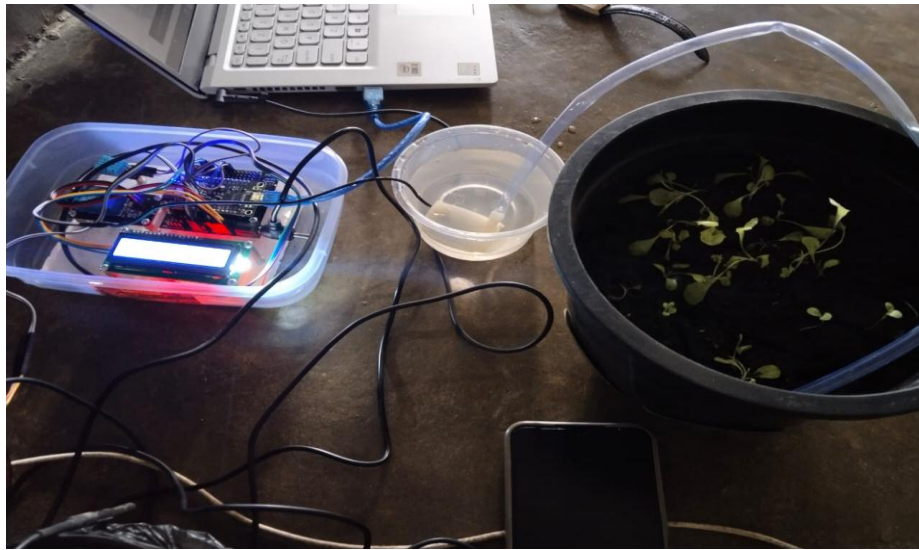
Gambar 4.5. Sistem penyiraman otomatis pada tanaman
