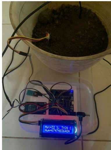
Gambar 4.10 hasil pengujian sensor dht11
